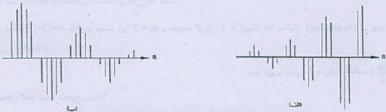
شکل ۹-۱ (الف) سیگنال سینوسی افزایش یافته (ب) سیگنال سینوسی میرا شونده
